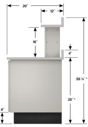
\* HEIGHT SHOWN IS BASED ON A 1 1/4" THICK WORK SURFACE. OVERALL HEIGHT VARIES DEPENDING ON THICKNESS.
