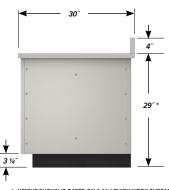
\* HEIGHT SHOWN IS BASED ON A 11/4" THICK WORK SURFACE. OVERALL HEIGHT VARIES DEPENDING ON THICKNESS.
